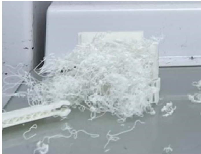
Figuur 3.11: Printfout stringing
