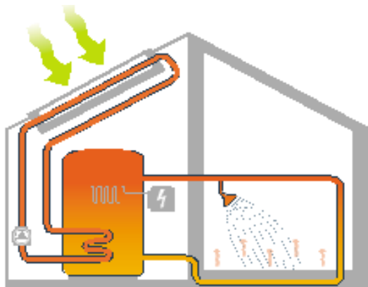
Figuur 5.7: Het werkingsprincipe van een actief zonnearmsysteem (Enova, Innovation Norway, NVE & The Norwegian Research Council, 2007, p. 14)
