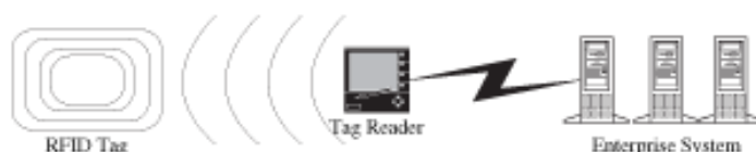
Figuur 3.1: Een typisch RFID systeem. (Roberts 2006)
