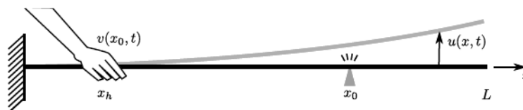
Figuur 15. Manipulatietaak uitgevoerd door Sreng et al. om verschillende vibratiepatronen te onderzoeken [30]
