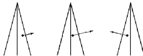
Figuur 39: Bij dunne objecten is het mogelijk door de figuur uit te duwen. Dat zou niet mogen.
