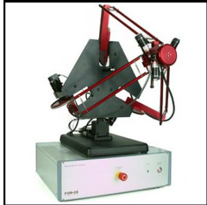
Figuur 32: Delta haptic device met zes vrijheidsgraden (c) Force Dimension
