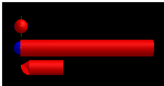
Figuur 48: De tools uit de CSG Modeller: de pointer (boven), de boor (midden) en de beitel (onder).
