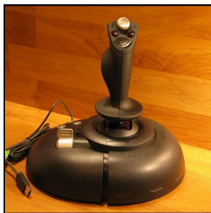
Figuur 27: Krachtterugkoppelende Joystick (Microsoft Sidewinder Pro)
