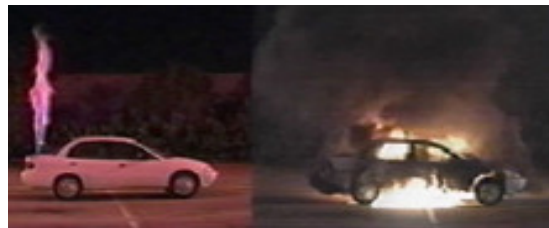
Figuur 5.9: Gevolg van een lek in de brandstoftank
