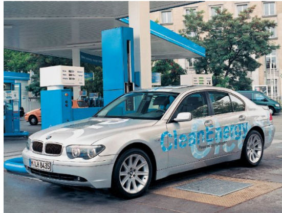
Figuur 5.2: BMW 745h met waterstof-vonkontstekingsmotor
