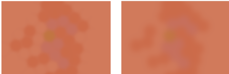
Figuur 4.6: Interpolatiemethode. (a) Circulaire artefacten door de weegfactor in 4.10 te gebruiken. (b) Reduceren van de artefacten met een Gaussiaanse weging volgens formule 4.11.
