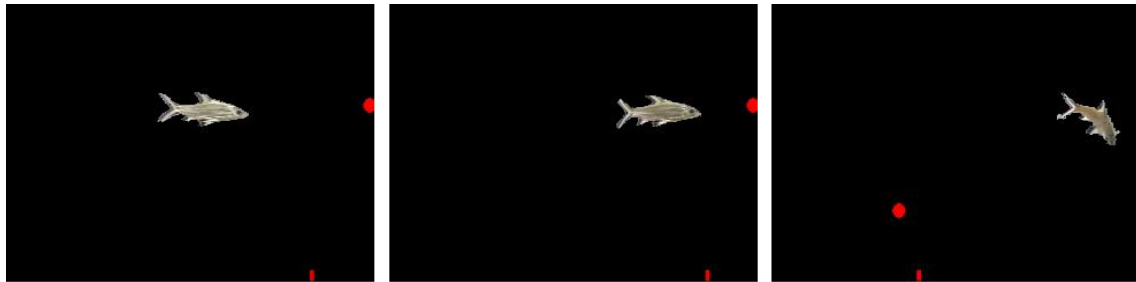
Figuur 7.6: Een animatie waar de gebruiker de bewegingen van de vis interactief kan veranderen. De muis beweegt voortdurend in de richting van de muispointer (rode stip). Er werden voor de 8 kompas richtingen toekomstige kosten berekend, en tijdens het veranderen van richting werden 5 frames gebruikt waar de velocity niet meetelde.
