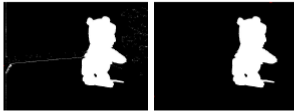
Figuur 3.3: Links is het masker bekomen na background subtraction. Rechts is hetzelfde masker na toepassing van erosie en dilatie. Een grote hoeveelheid van de ruis is verwijderd. Toch is het silhouet nog niet ideaal, en blijft een kleine hoeveelheid ruis aanwezig.
