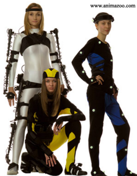
Figuur 2.2: Verschillende motion capture systemen: mechanisch (wit), optisch (blauw) en inert (geel).
