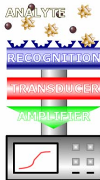
Figuur 1. Schematische weergave van een sensor
