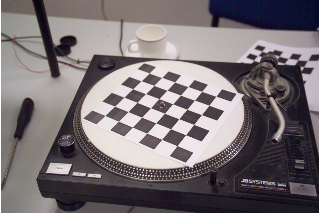
Figuur 2.1: Voorbeeld van een calibratie patroon
