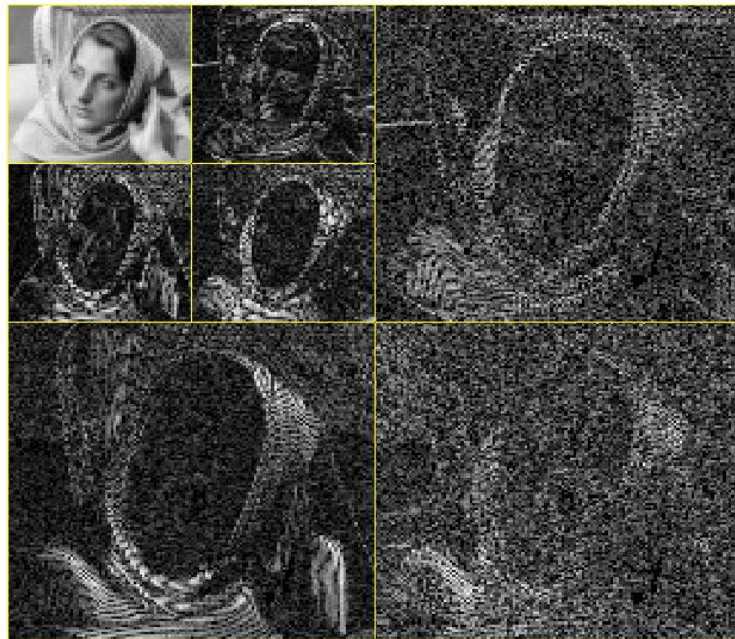
Figuur 39: 2D niet-standaard wavelet decompositie (2 iteraties) van Figuur 38 met de Box scaling function en Haar wavelet.
