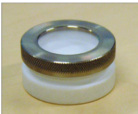
Figuur 25: De luchtdichte opstelling, bestaande uit een metalen deksel met kwartsraam en teflon reservoir met schroefdraad
