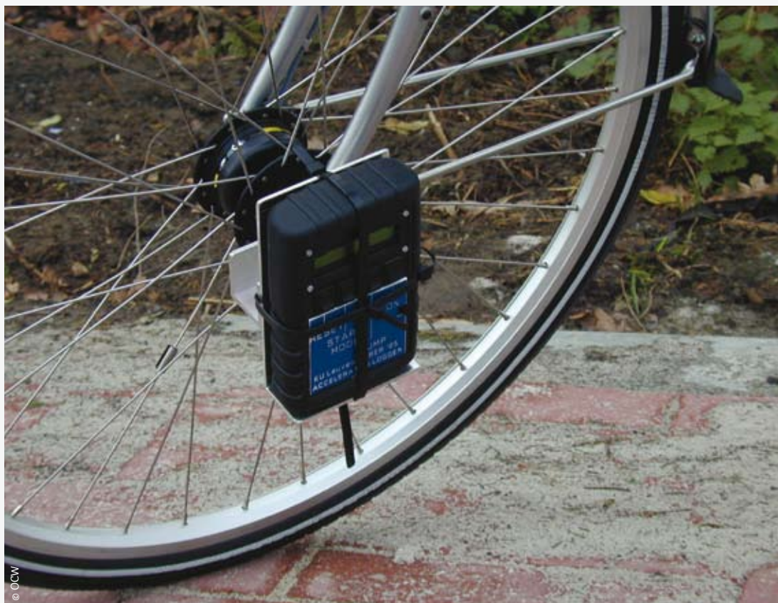
Het onderzoek werd uitgevoerd met een meetfiets ontworpen aan de KULeuven
