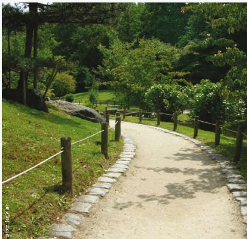
Eenvoudig en esthetisch geïntegreerde visuele en tactiele markering voor bezoekers met visuele beperkingen (Japanse tuin, Hasselt)
