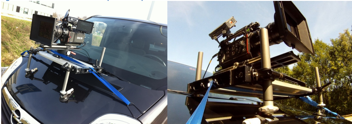
Figuur 1 Gemonteerde camera op motorkap
