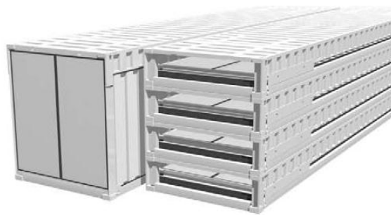
Figuur 5: Eén 'gewone' container versus vier opvouwbare containers (uit Shintani et al., 2010)
