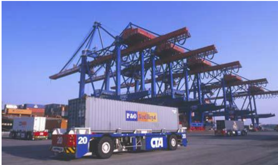
Afbeelding 14: Een voorbeeld van een automatic guided vehicle (AGV) (Steenken et al., 2004)
