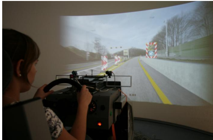
Figuur 2: Signalisatiesimulator mock-up met eye-tracking systeem
