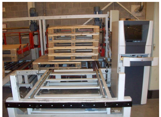
Figuur 18: de goede pallets gaan naar links, de slechte gaan naar onder op de tekening
