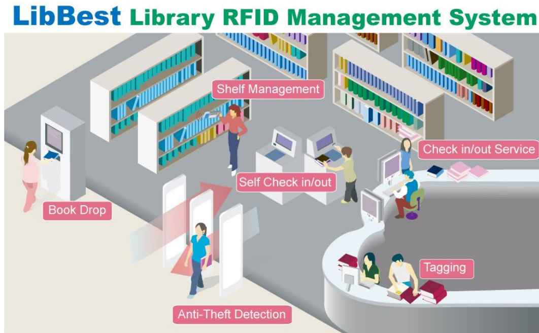
Figuur 7: een RFID-systeem in een bibliotheek
