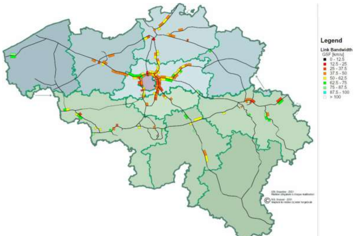
Figuur 32 Kaartplot: Gemiddelde snelheid in de file (GSF) voor 2005 (voor de werkdagen). Enkel de wegvakken waarvoor op minstens 15 dagen file werd geregistreerd, worden beschouwd.
