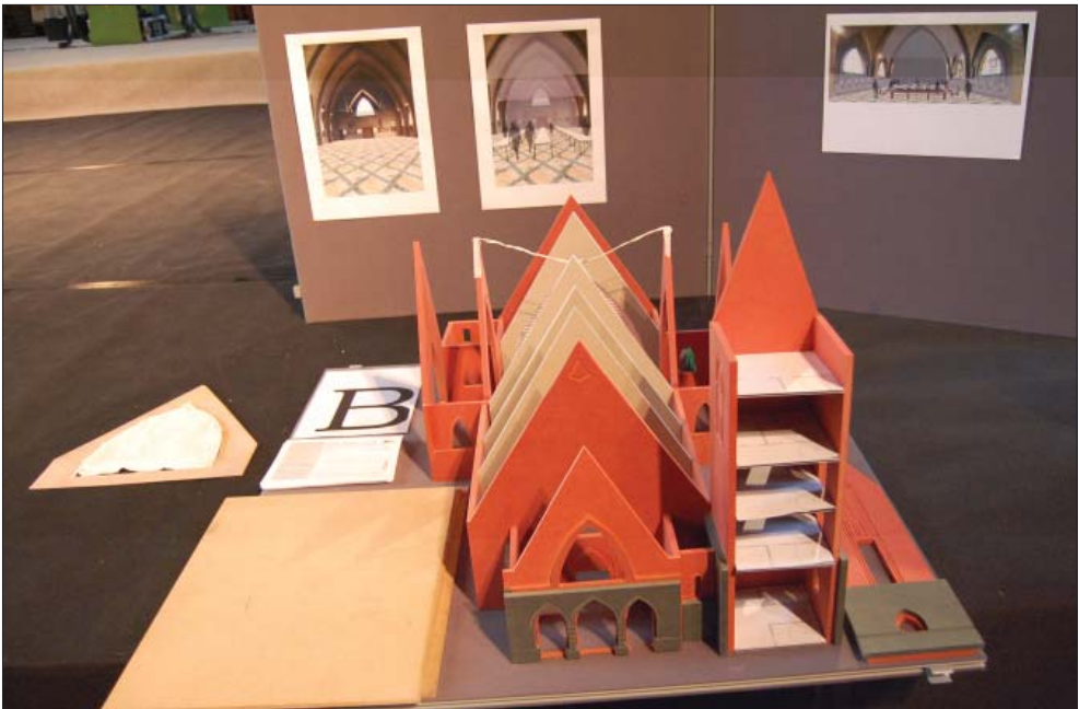
Afbeelding 6.2: het agora-scenario met het vrije en indeelbare kerkschip en de woonunit in de toren.
