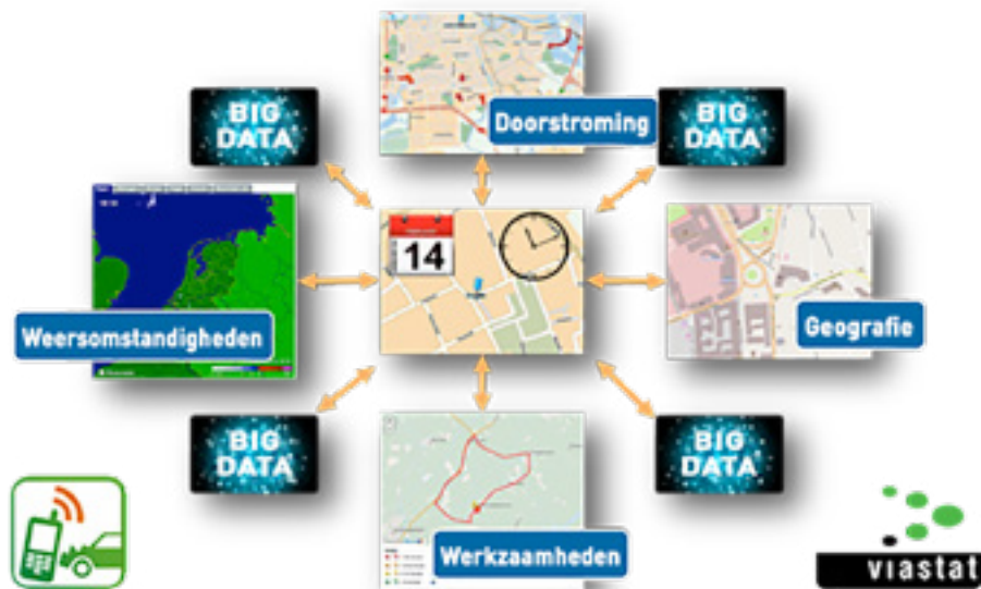
Figuur 3: Smart formulier - door digitale koppelingen met verschillende online databases wordt het ongevalregistratieformulier voor een deel automatisch ingevuld.
