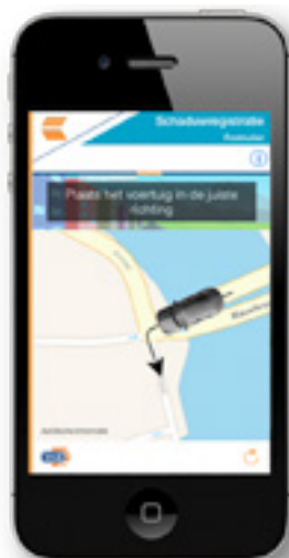
Figuur 2: Voorbeeld van het manoeuvrediagram zoals dat met de smartphone wordt getekend door gebruik te maken van de gps en het kompas.
