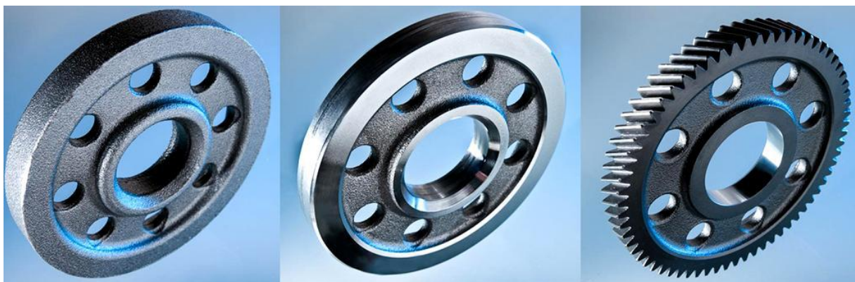
Figuur 4: productie van een tandwiel
