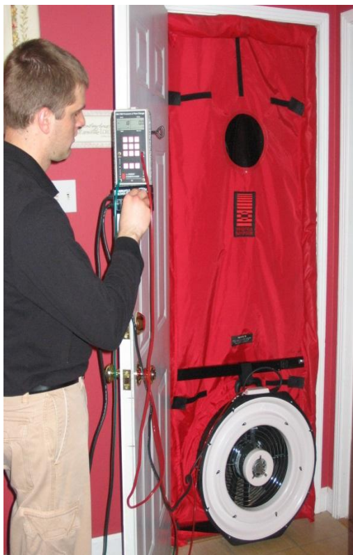
Figuur 19: Pressurisatie-apparatuur blowerdoortest [50]
