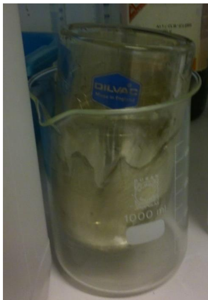
Figuur 30: Aangetast Dewar-vat.
