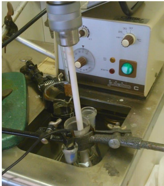
Figuur 20: Opstelling bij de experimenten bij gecontroleerde koeling zonder externe menging : 200 ml driehalskolf in thermostatisch bad type Julabo MP met een roerder en een chromium-aluminium thermokoppel type K.
