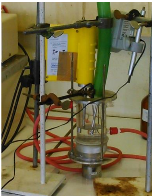
Figuur 22: Opstelling bij de experimenten in een 300 ml reactor met glazen koelwand : 300 ml reactor met glazen koelwand gekoppeld aan een thermostatisch bad type Julabo MP met een roerder en een chromium-aluminium thermokoppel type K.
