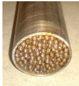
Figuur 44: profiel gevuld met MHS-schuim
