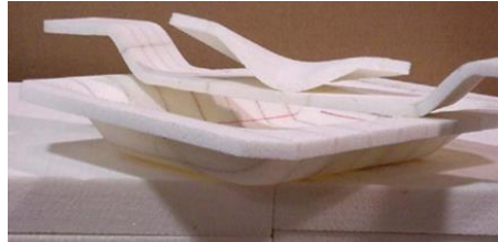
Figuur 14: thermovorming van PET-schuim [20]
