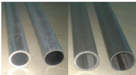
Figuur 19: aluminium (links) en stalen (rechts) profielen met Ø30x3 en Ø30x1,5
