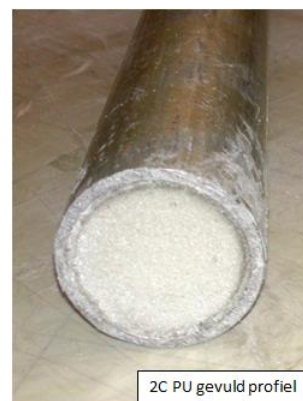
Figuur 39: profiel met volledige 2C PU-vulling
