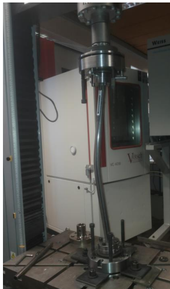
Figuur 34: uiterste positie actuator (profiel bezweken)
