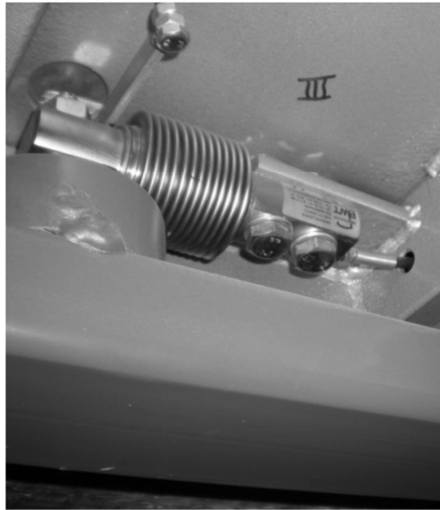
Figuur 37: één van de vier weegsensoren op het MOP-toestel.
