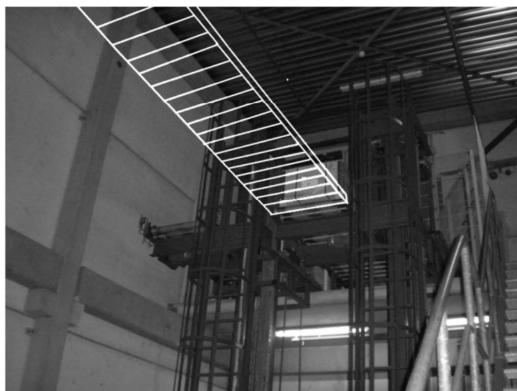
Figuur 32: een schets van de conveyor verbonden met de lift van CON H.
