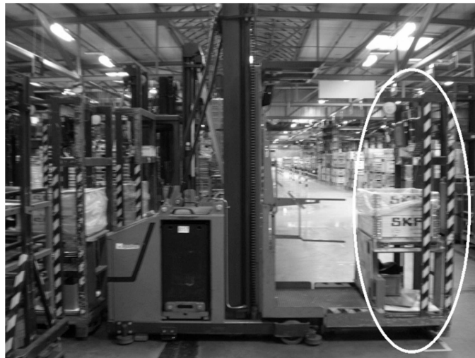
Figuur 2: een mobiele orderpicker met een MOP-toestel voor palletkisten.
