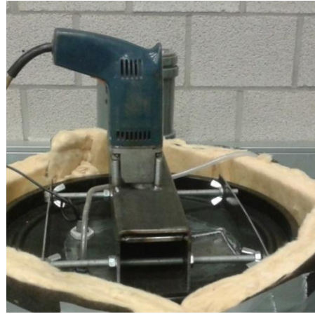
Figuur 16: Boormachine als menger
