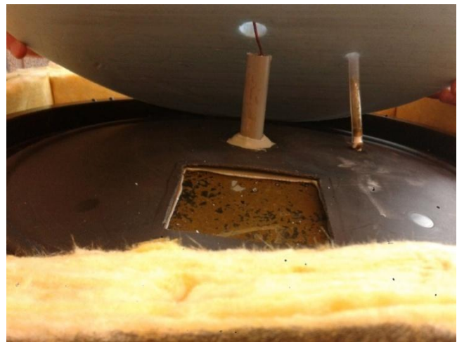
Figuur 14: Vervorming deksel door drukopbouw
