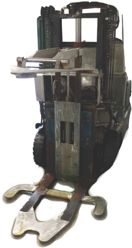
Fig. 7 Vork van een heftruck om schotels op te nemen
