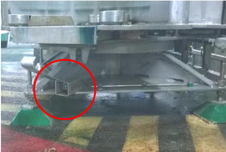
Fig. 51 Detectie van heftrucks met behulp van een lasersensor
