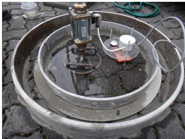
Figuur 20: Dubbele ringopstelling gedurende de meting.
