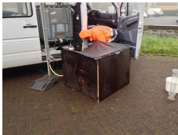
Figuur 19: Inzet van een overkapping bij de dubbele ringopstelling.
