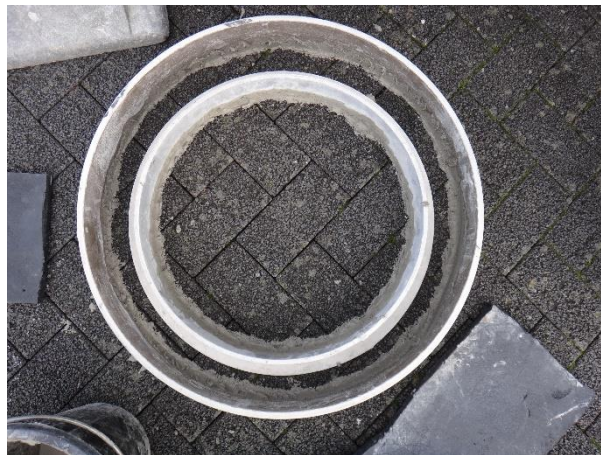
Figuur 17: De binnenste en buitenste ring verlijmd met cementpasta op het bestratingsoppervlak.
