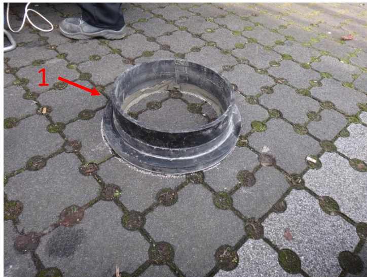
Figuur 21: Onderdelen van een enkele ringmethode.
