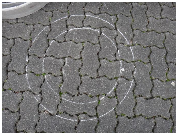
Figuur 16: Aangebrachte krijtmarkeringen van de ringen op het bestratingsoppervlak.
