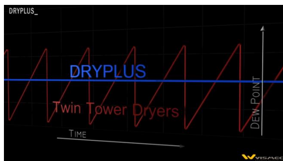
Figuur 29: Constant dauwpunt roterende honinggraatdroger (Moretec, 2013)
