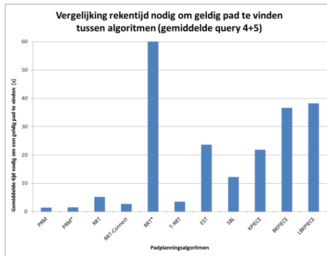
Figuur 115: Padplanningsalgoritmen i.f.v. gemiddelde rekentijd nodig om een geldig pad te vinden, toegepast op query 4 en 5
