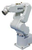
Figuur 1: De zesassige Epson C3 robot die op ACRO geïntegreerd is in een 3D-bin picking setup [1]
