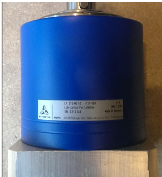
Figuur 8: Reductiekast van Wittenstein Alpha
