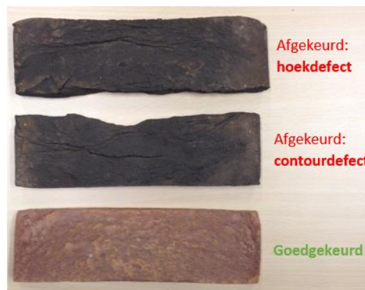
Figuur 83: gecontroleerde steenstrippen
