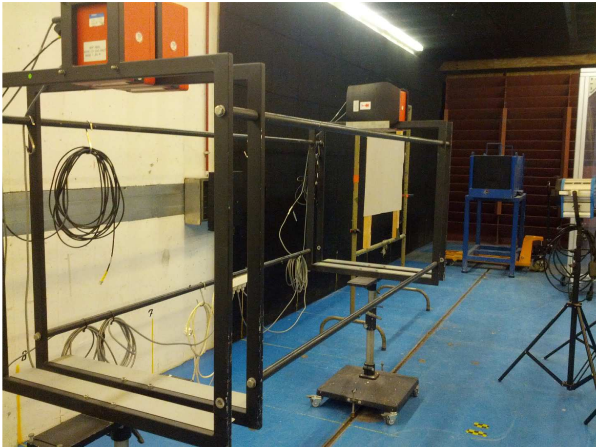
Figuur 2: de meetbasis van Drelo die gebruikt wordt in het labo ballistiek
