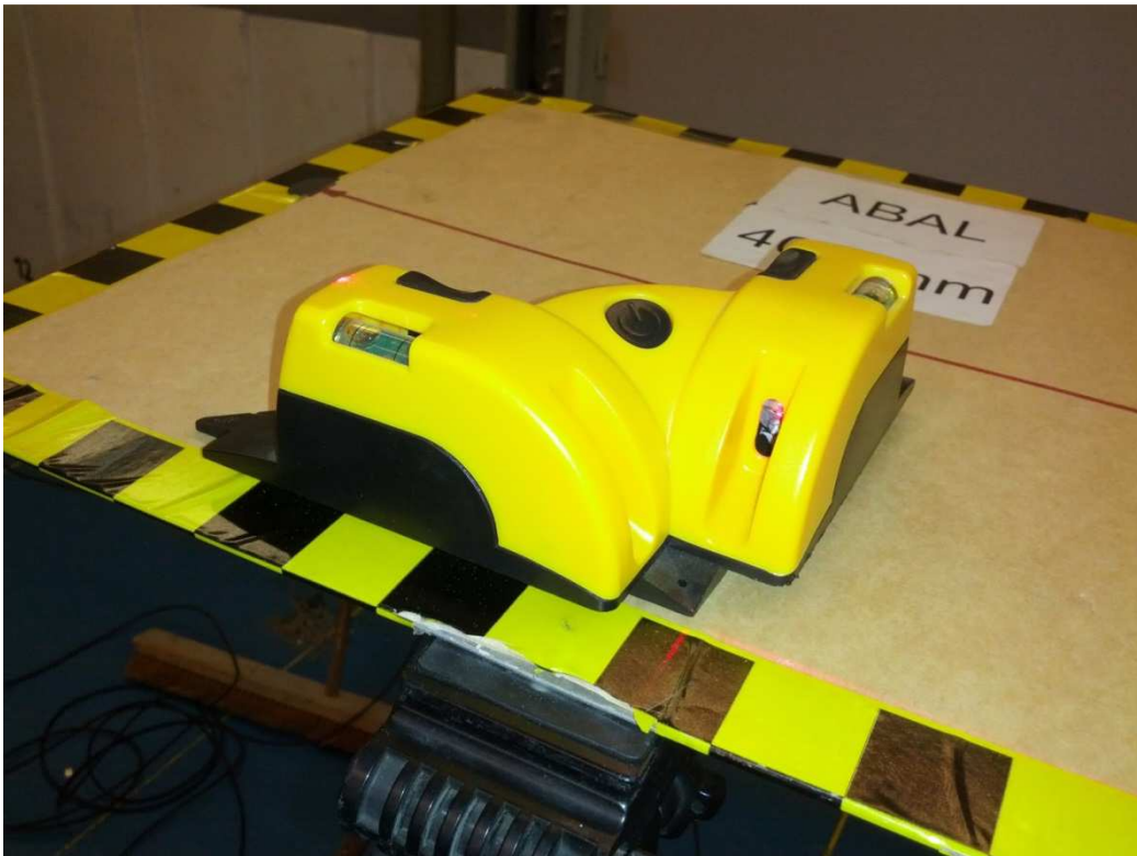
Figuur 21: apparaat met twee loodrechte laserstralen
