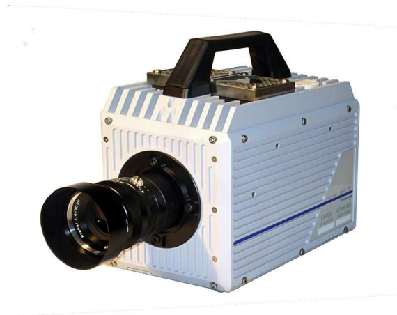
Figuur 11: Photron Fastcam SA5 digitale hogesnelheidsvideocamera [9]
