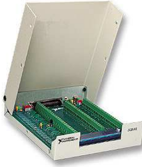
Figuur 8: een SCB-68 break-out box
