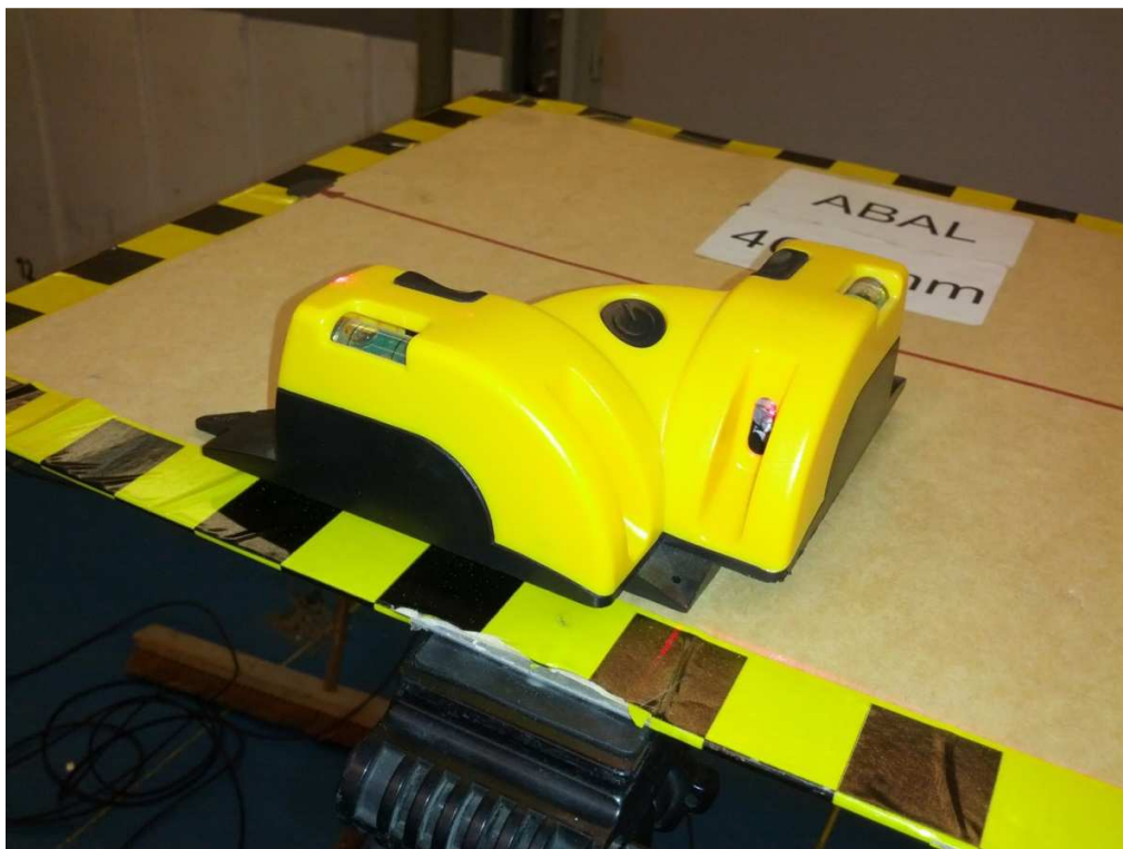
Figuur 3: apparaat met twee laserstralen die loodrecht ten opzichte van mekaar opgesteld staan
