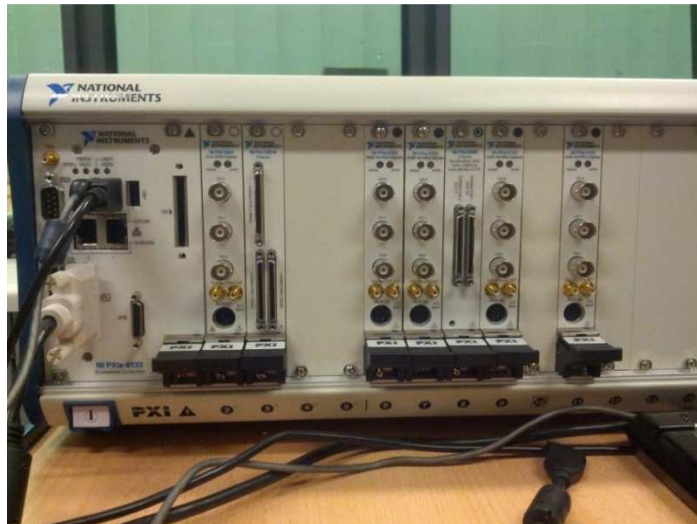
Figuur 7: National Instruments PXI met een FPGA kaart in slot 3
