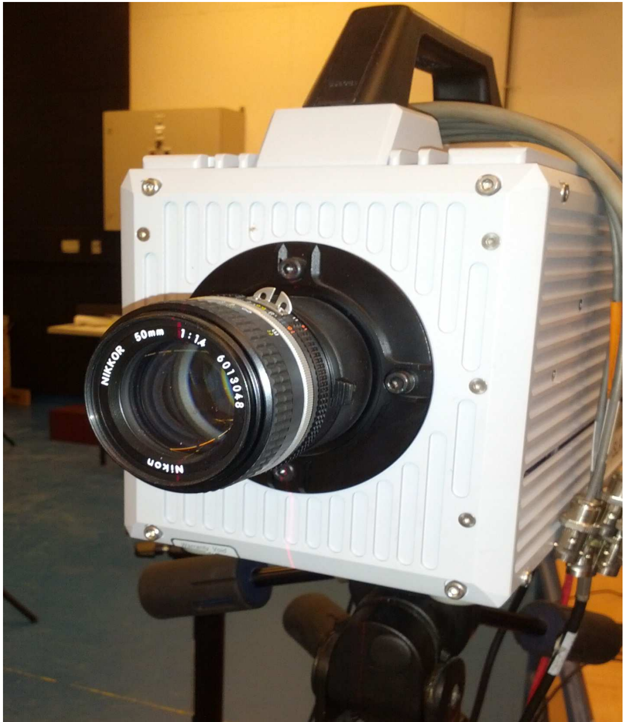
Figuur 23: de Photron camera met de opgelijnde laserlijn zichtbaar
