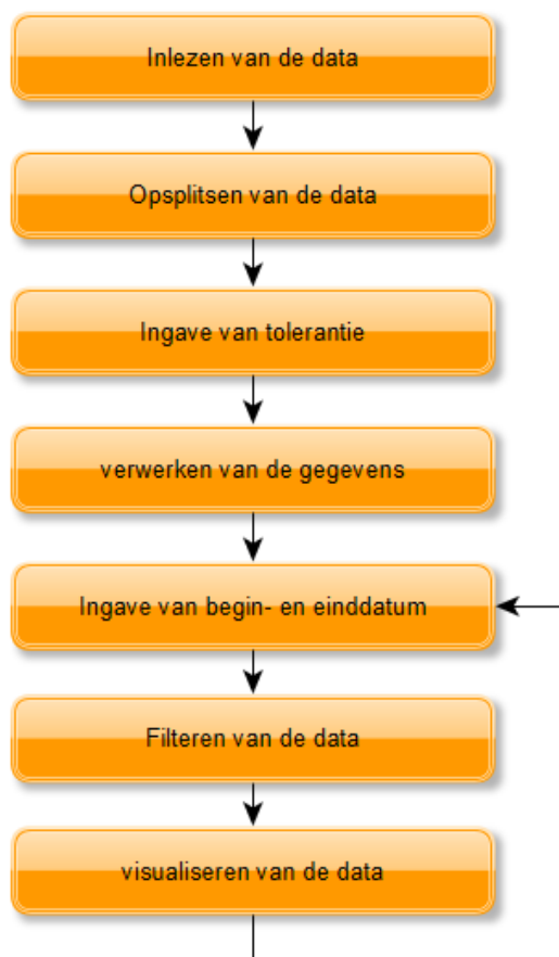
Figuur 10 Schematische weergaven van de basiswerking van de Excelapplicatie
