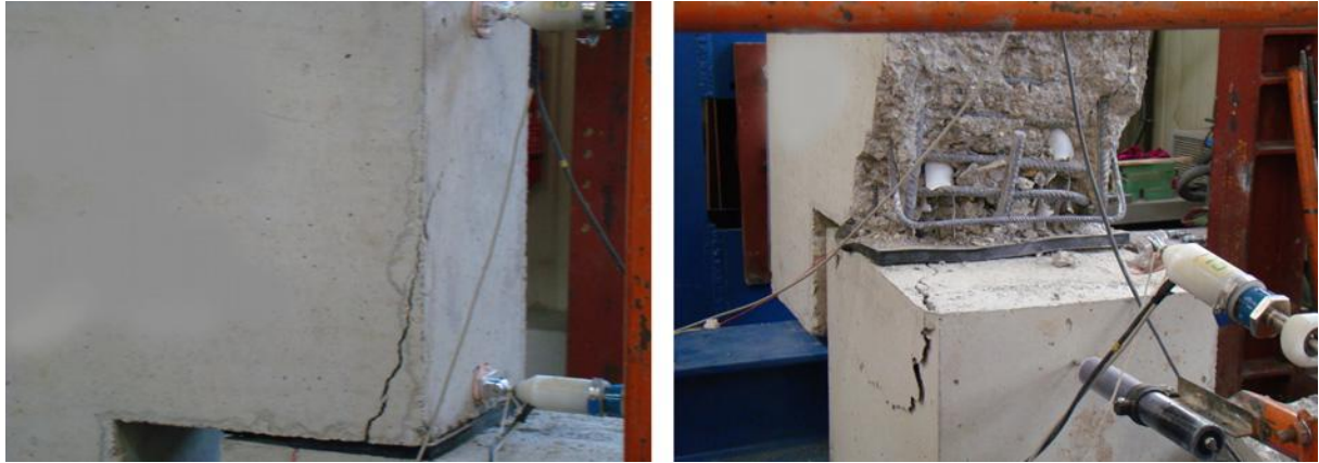
Figuur 2.23: Beton verbrijzelt [17]
