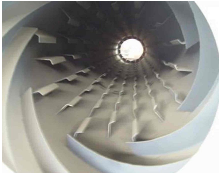
Figuur 40: Droogtrommel met spiraalvormige schoepen
