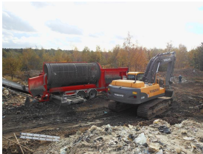
Figuur 43: Testopstelling: opgravingen en trommelzeef
