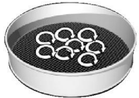
Figuur 11: Beweging materiaal bij een circular screen scheider
