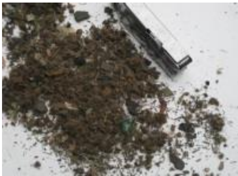
Figuur 52: Na exacte sortering: zand, papier, karton, folies en stukjes hout
