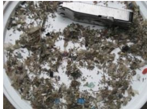
Figuur 51: Na exacte sortering: glas en plastic
