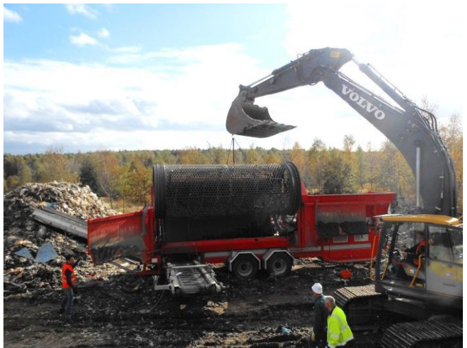
Figuur 45: Verwisselen trommel met kleinere zeefopeningen
