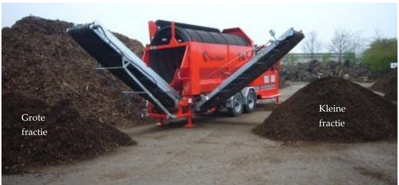
Figuur 47: Testopstelling met verdeling grote en kleine fractie
