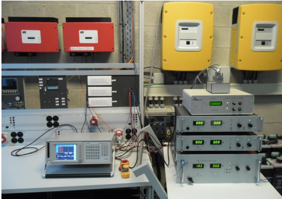
Figuur 86: Regelbare zonne-instraling met behulp van PV-simulator en gelijkspanningsbron
