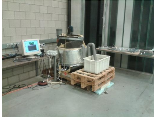
Figuur 22: Biogasinstallatie met geoptimaliseerd regelsysteem
