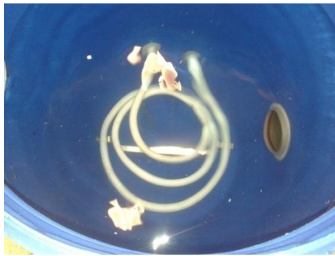
Figuur 12: Spiraalvormige alpex buis op de bodem van het vat
