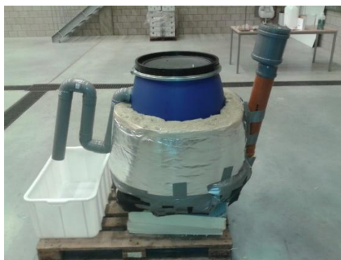
Figuur 13: Vergistervat met isolatie
