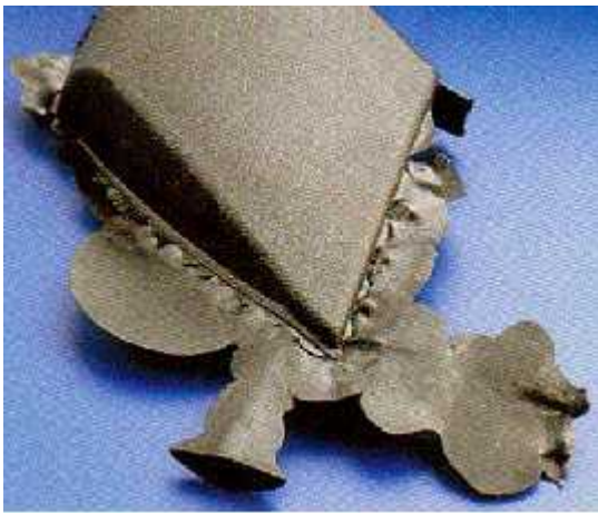
Figuur 18: Voorbeeld van braamvorming [2]
