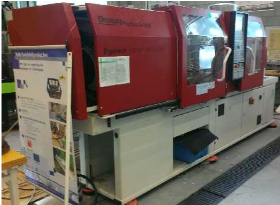
Figuur 8: Spuitgietmachine (DEMAG ERGOTECH INTELECT 50/330-100)
