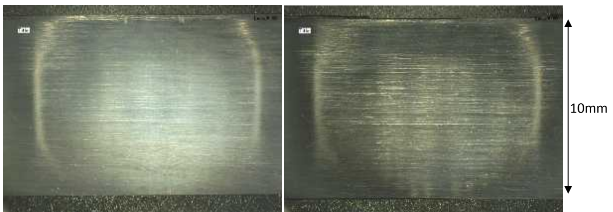
Figuur 43: Trekstaafjes zonder defecten (PC ABS links en PC rechts)
