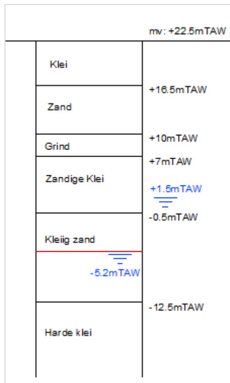
Figuur 15: Waterniveaus binnen en buiten de beschoeiing
