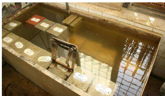
Figuur 50: watertank betonproef
