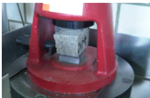
Figuur 61: drukproef mortelbalkje
