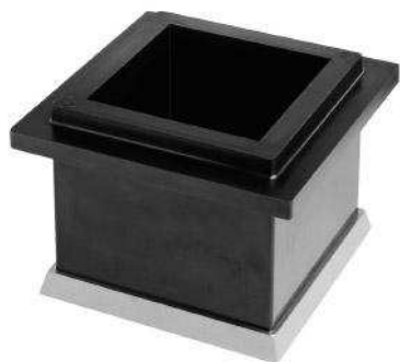
Figuur 49: mal betonkubus
