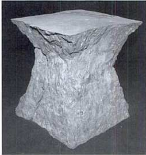
Figuur 51: geteste betonkubus
