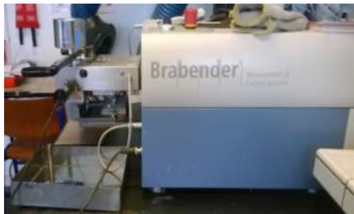
Figuur 4.3: Brabender (Measurements & Control systems), links bevindt zich de mengkamer.
