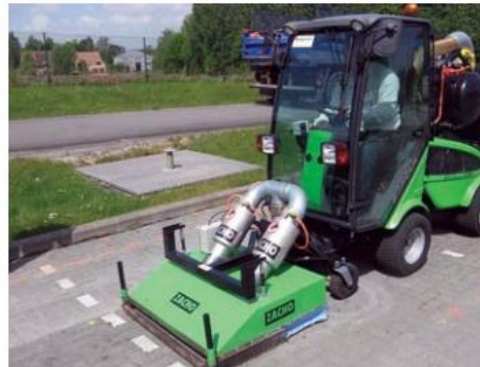
Figuur 3: Heteluchttechniek, het onkruid komt niet in contact met de vlam maar wel met wervels van hete lucht [1].
