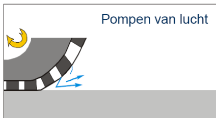
Figuur 4 & 5: Aerodynamische geluidsofwekking: Pompen van lucht (links) en het Hoorneffect (rechts) [4].
