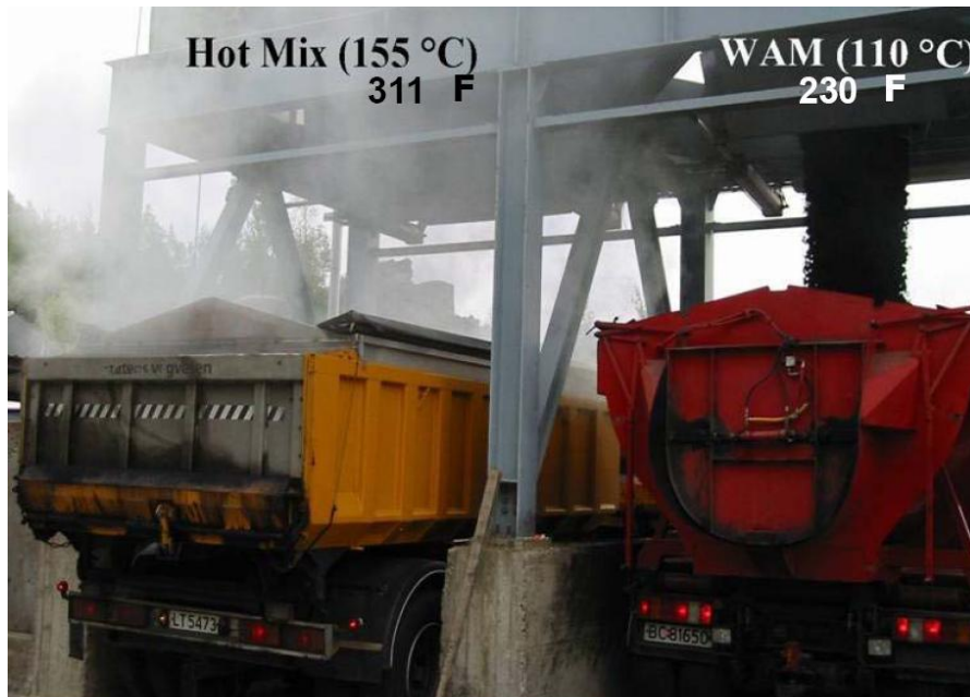
Figuur 2: dampen van bitumen bij verschillende temperaturen [2].
