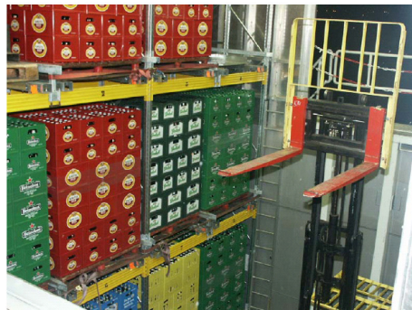
Figuur 29: Volautomatisch overslagsysteem in het ruim van een binnenschip Bron: Promotie Binnenvaart Vlaanderen, 2003
