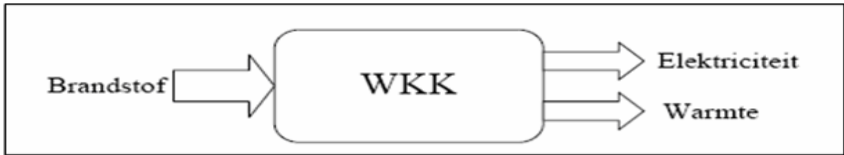
Figuur 2: Schematische definitie van warmtekrachtkoppeling
