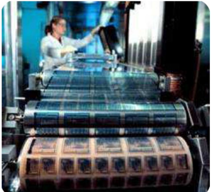
Figuur 2: Het printen van elektronica circuits (PolyIC, 2007b)
