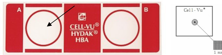
Figuur 10: Het HBA testglaasje (links) met een CELL-VU dekglasje (rechts). Een testglaasje bevat 2 kamers (A en B) die bedekt zijn met een hyaluronzuurlaag. Het dekglasje bevat een rooster met 100 vierkantjes.
